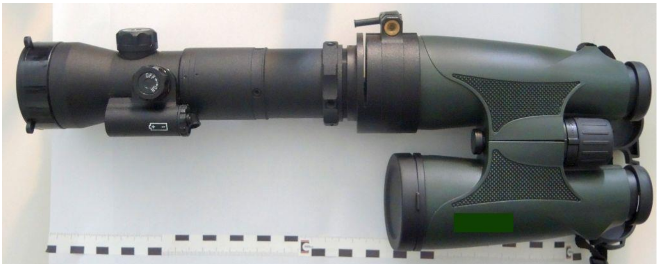
Abbildung 3: Nachtsichtvorsatzgerät „Lynx 1x53“, montiert an einem Fernglas 12x56
